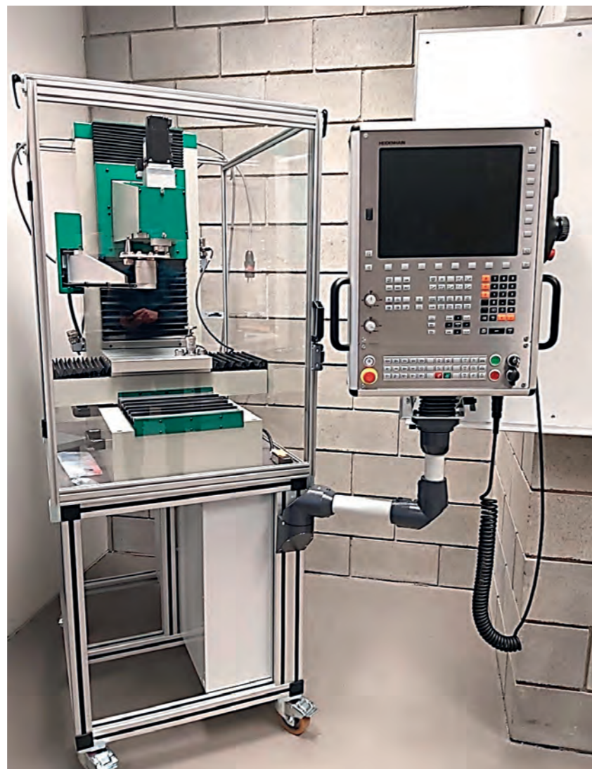
Trenażer szkoleniowy pozwalający na pracę w rzeczywistym środowisku obrabiarki
