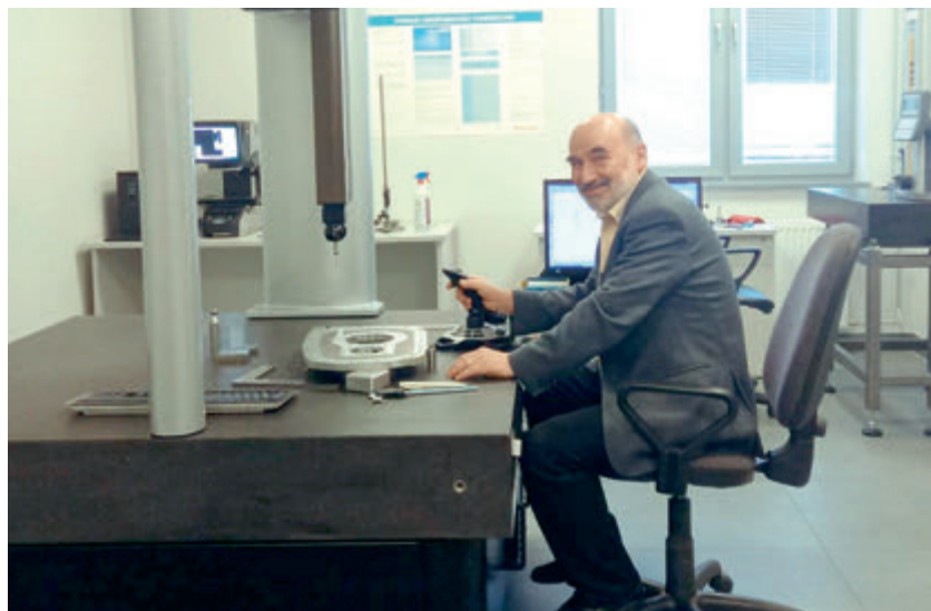
Systemem pomiarowy Keyence, o dokładności do 0,002 mm, automatycznie tworzy i zapisuje raporty statystyczne, z możliwością wydruku lub eksportu do urządzeń zewnętrznych
