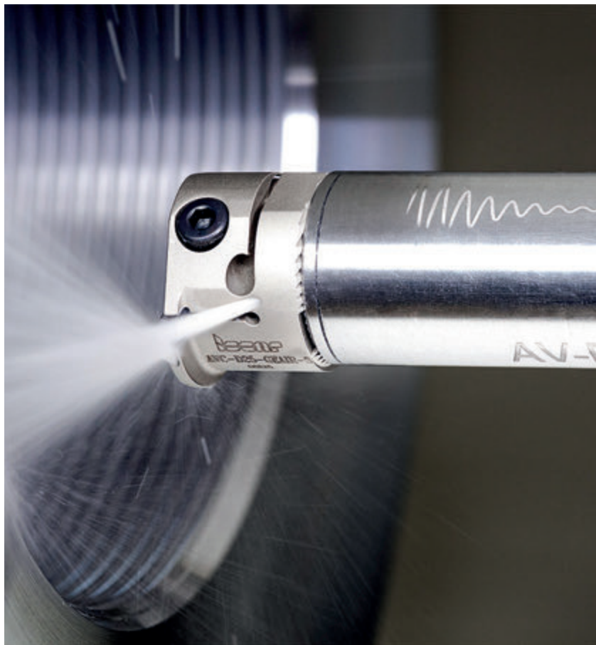
Ryc. 3. Trzpień antywibracyjny z wymienną głowicą i połączeniem ząbkowanym znacznie rozszerzają zakres zastosowania do wytaczania i gwintowania
