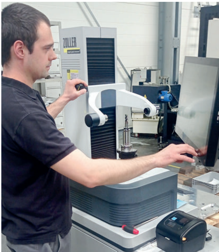
W pomiarze narzędzia urządzeniem „smile/pilot 2 mT” kluczym elementem jest optyka
