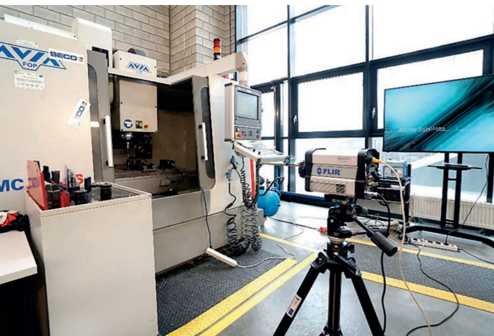
Stanoisko pomiarów termowizyjnych w Katedrze Podstaw Inżynierii Produkcji
