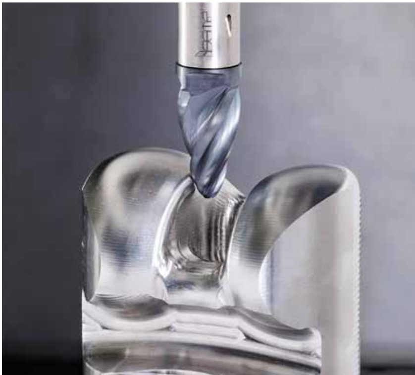
Fot. 4. Zastosowanie małego frezu barytkowego znacząco redukuje czas cyklu obróbki protezy kolana
