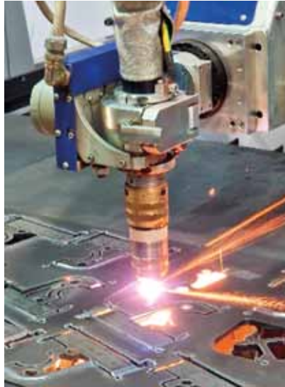
W trakcie trwania Przemysłowej Wiosny 2023 firma Eagle Laser zaprezentowała wycinarkę laserową iNspire o mocy 30 kW
