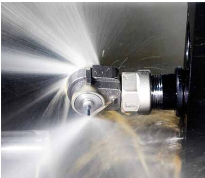
Fot. 5. Kompaktowa oprawka MICRO90 napędzana chłodziwem to efektywne narzędzie do zwiększenia prędkości obrotowej miniaturowych narzędzi skrawających
