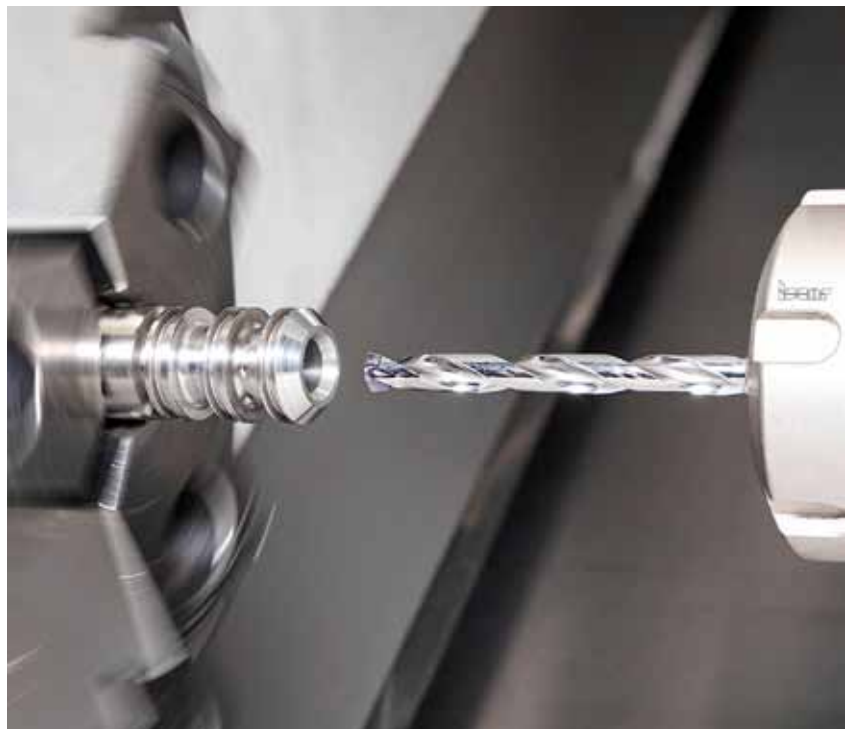
Fot. 3. Składane wiertło SUMOCHAM z wymienną węglkową główką – teraz dostępne od średnicy \varnothing 4.5 mm
