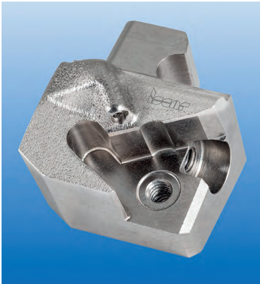
Fot. 2. Kompletnie ukształtowana głowica NEOSWISS, przeznaczona dla obrabiarek typu szwajcarskiego, jest modułową głowicą szybkowymienną systemu stworzonego dzięki technologii drukowania 3D
